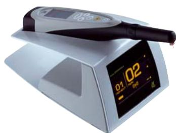
All'interno dello strumento viene prodotta una luce con lunghezza d'onda di 655 nm che viene poi portata da un fotoconduttore sulla punta all'estremità del manipolo. Un secondo fotoconduttore, incorporato nel manipolo, riceve la luce fluorescente dalla sostanza in questione e la porta ad un filtro. Dietro a questo filtro si trova una fotocellula che analizza la luce ricevuta.
